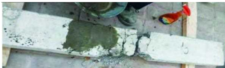
شکل ۲: مقاوم‌سازی نمونه کنترل آسیب دیده
