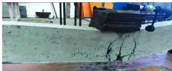
(ب) تیر مقاوم شده با FRP بدون پیش‌تنیدگی
