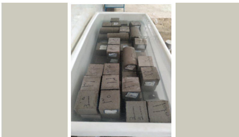
شکل ۴: عمل آوری نمونه‌های مکعبی و استوانه‌ای استاندارد
