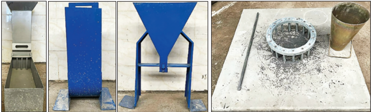
شکل ۱: آزمایش‌های مربوط به بتن خود متراکم: (الف) حلقه ز (ب) آزمایش قیف ۷ شکل (ب) آزمایش جعبه I شکل (ت) آزمایش جعبه U شکل
